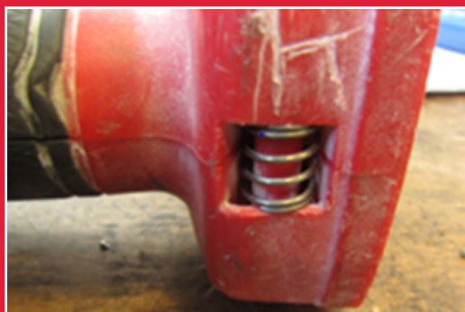
Pružina namontovaná externě, což dokazuje neoprávněné otevření nástroje
