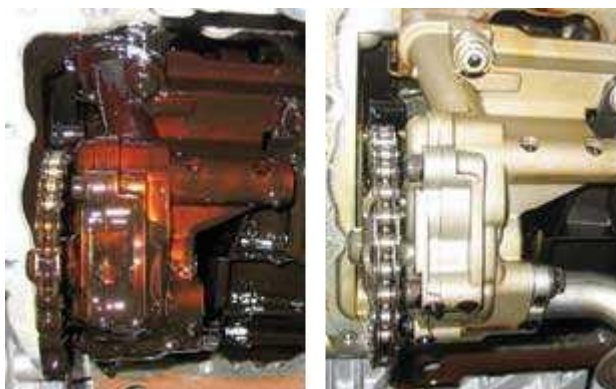
Volkswagen/Audi motor testovaný v Evropě Motor zanesený po ujetí 32 500 km.
