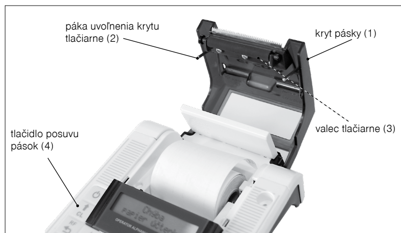
Obrázok 2.6 – Zavedenie papierovej termo pásky do tlačiarne pokladnice
