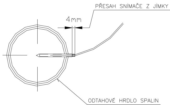
SPRÁVNÉ ZAPOJENÍ KABELU SNÍMAČE TEPLITY SPALIN
