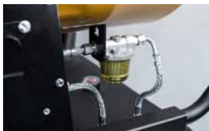
Předehříváč paliva na objednávku, palivový filtr venku.
