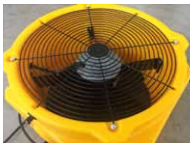
Axiální ventilátor DFX 20, lze nastavit do 8 různých pozic.
