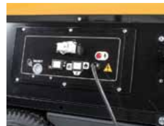
Ovládací panel se zásuvkou pro připojení termostatu (analogového nebo digitálního)
